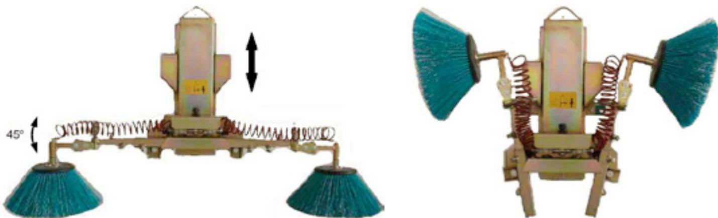
1 cilindro per regolazione idraulica di altezza e chiusura verticale bracci, terminali a spazzole rotanti antideriva a snodo antiurto e regolazione di inclinazione verticale fino a 45°, elettrovalvole e comando elettrico a distanza; kit tubazioni olio completi di attacco rapido
