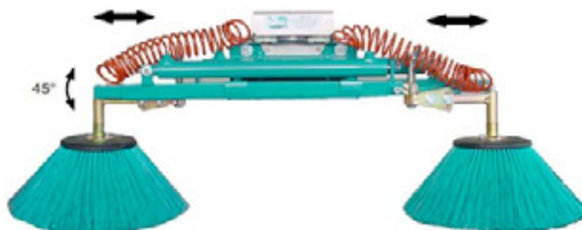
2 cilindri per regolazione idraulica in larghezza, terminali a spazzole rotanti antideriva a snodo antiurto e regolazione di inclinazione verticale fino a 45°, elettrovalvole e comando elettrico a distanza; kit tubazioni olio completi di attacco rapido
