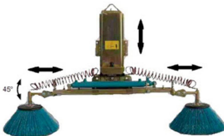
3 cilindri per regolazione idraulica di altezza e larghezza, terminali a spazzole rotanti antideriva a snodo antiurto e regolazione di inclinazione verticale fino a 45°, elettrovalvole e comando elettrico a distanza; kit tubazioni olio completi di attacco rapido
