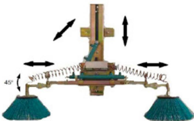
4 cilindri per regolazione idraulica in altezza – larghezza – inclinazione laterale, terminali a spazzole rotanti antideriva, a snodo antiurto e regolazione di inclinazione verticale fino a 45°, elettrovalvole e comando elettrico a distanza
